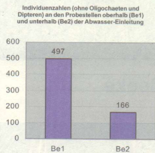
12 Individuenzahlen zweier Probestellen (Be1 oberhalb und Be2 unterhalb der Abwasser-Einleitung) im Vergleich: Die Individuenzahl ohne die anspruchslosen Wenigborster (Oligochaeten) und Zweiflüglerlarven (Dipteren) ging unterhalb der Abwasser-Einleitung deutlich zurück.
